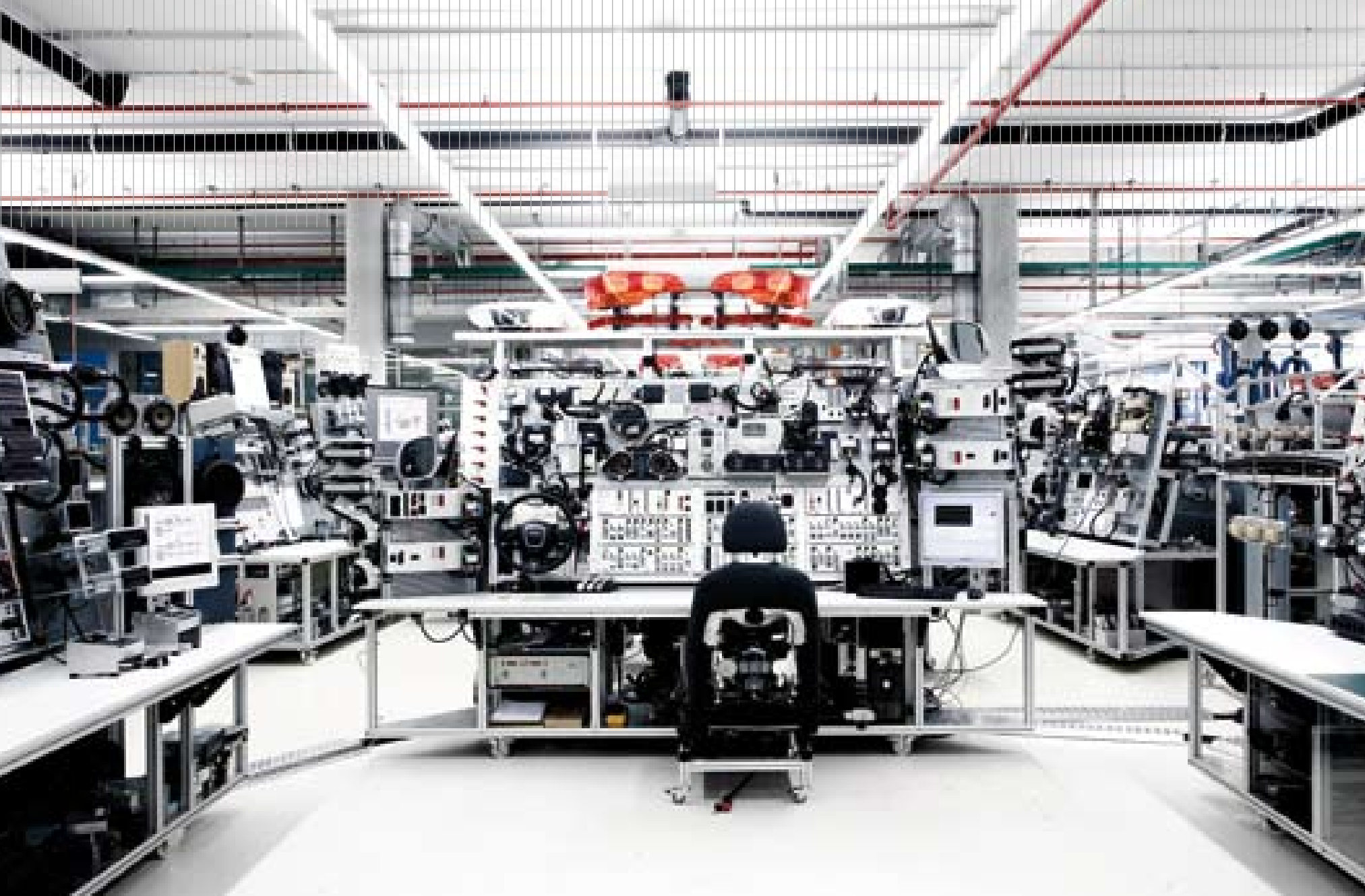
Das komplette Innenleben eines Audi Q7: Jede elektronische Funktion wird hier überprüft. Diesen Aufbau gibt es für jedes Audi Modell.
