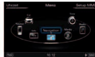
**Menü:** Anzeige der zur Verfügung stehenden sieben Untermenüs, die alternativ auch über die Hardkeys anwählbar sind.
